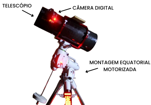
Figura 1: telescópio com câmera digital em montagem equatorial motorizada, permitindo rastreamento do céu e captura de imagens para análise didática. (Autorial, 2025)
