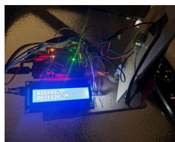
Figura 3: Interface de leitura do instrumento com valores de altitude e azimute.
